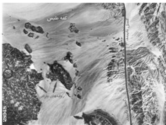
شکل ۹-۸-الف) روانه‌های بازالتی گوانرنری جنوب طیس که از محل گسل نایبند به سطح زمین رسیده‌اند. گدازه‌های بازالتی به صورت سر تخت‌های افقی تیره رنگ سنگ نهشته‌های تریاس بالایی را می‌پوشانند.
