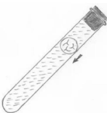
شکل ۷: حرکت یکنواخت گلوله به طرف پایین (آزمایش دانش آموزی)
